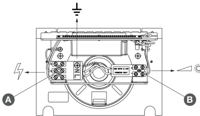
**IT** Fig.3E L'apparecchio può funzionare in modalità **SWITCH** (on-off) o in modalità **DIMMING** (dimmerabile):
